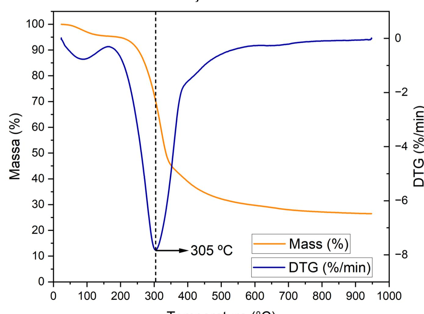
O gráfico acima representa a degradação térmica da amostra em natureza, podemos observar que há 2 decaimentos de massa principais, o primeiro em torno de 100°C que representa a humidade presente na amostra, e o segundo, maior na faixa de temperatura de 305°C representado hidrocarbonetos de baixa volatilização.
