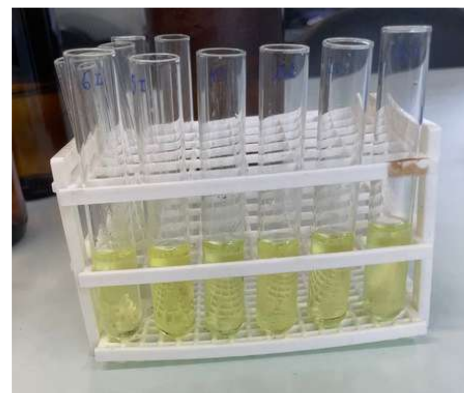
Figura 2- Tubos com a amostra de cor amarela indicando a presença de substrato não consumido
