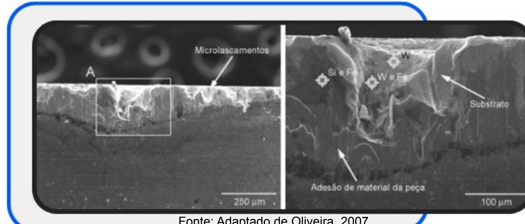
Fig 3. Desgaste no fresamento
