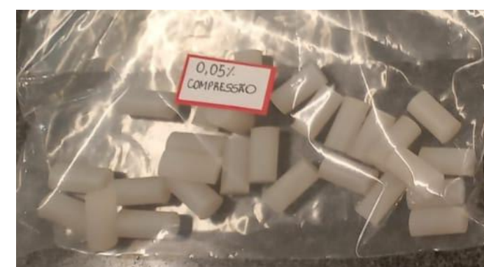
Figura 05 - Amostras submetidas aos testes de compressão.
