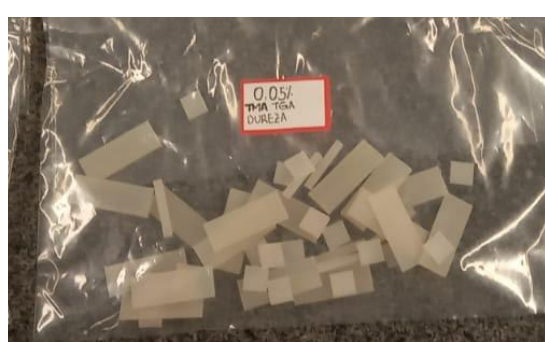
Figura 01 - Corpos de prova para submissão aos testes de dureza Shore D.
