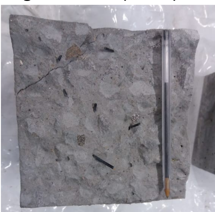
Figura 5 – Corpo de prova após ruptura
