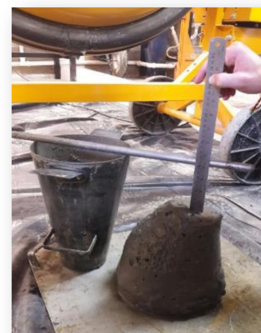
Figura 5 – Ensaio de abatimento de tronco de cone segundo norma NBR NM67:1998
