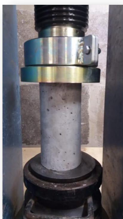
Figura 4 – Ensaio de compressão axial
