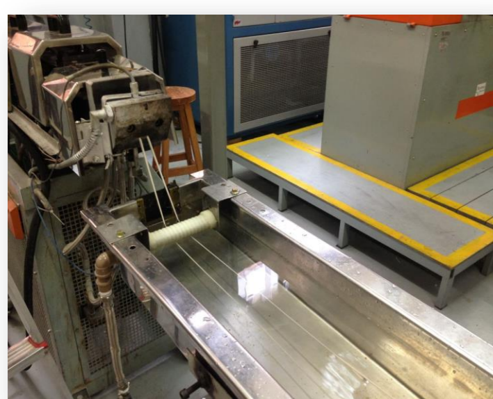
Figura 1 – Extrusão de fibras de PP
