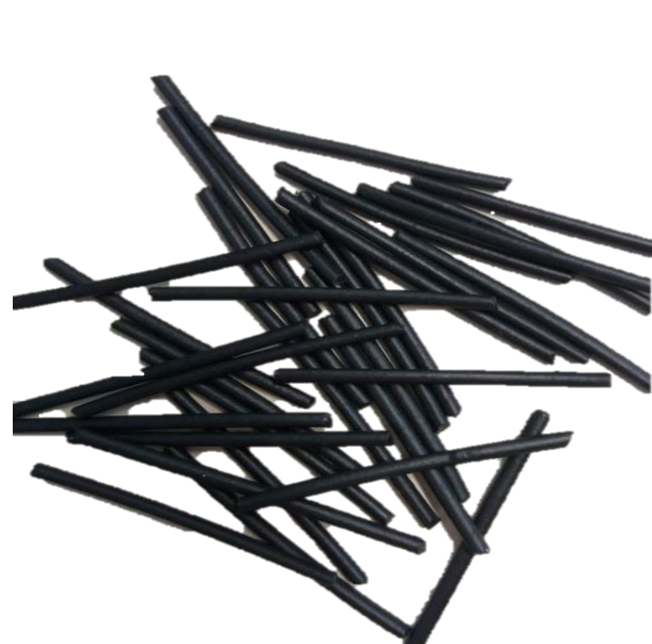
Figura 1 - Fibras PP com 4cm de comprimento de acordo com a dimensão máxima do agregado graúdo
