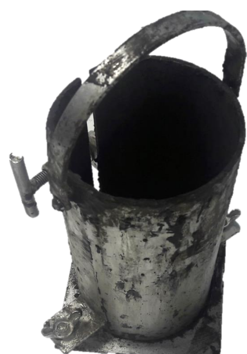
Figura 2 - molde cilíndrico utilizado para moldagem dos corpos de prova de acordo com a ABNT NBR 5738:2015
