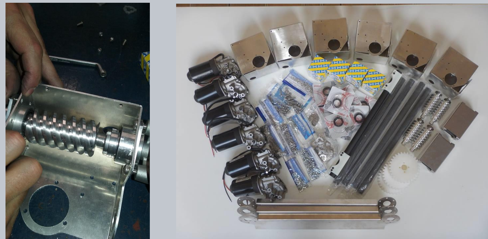
Engate do parafuso sem-fim no eixo do motor (esquerda), todo o material utilizado no exoesqueleto
