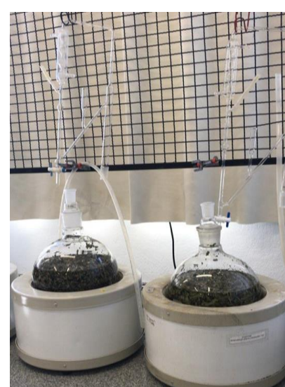
Extração do óleo essencial por meio de hidrodestilação – aparelho Clevenger Foto: Thomazoni, R.A., (2018)
