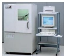
Na análise de DRX, utilizou-se um equipamento da marca Shimadzu, modelo XRD-6000, radiação monocromática de  $\text{Cu K}\alpha$  ( $\lambda = 0,1542 \text{ nm}$ ), corrente de 30 mA e tensão de 40 kV numa faixa de  $2\theta = 2^\circ$  a  $40^\circ$ , com velocidade de varredura de  $2^\circ/\text{min}$ .
