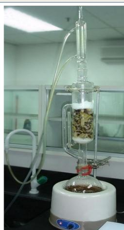
Figura 2: Aparelho de Soxhlet
