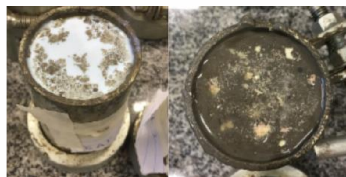
Fig. 2: Corpos de prova cilíndricos com aplicação de resina acrílica e inserção de vidro cerâmico luminescentes.
