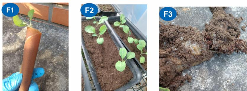
Figura – F1 - Preparação do filme para o plantio F2 - Plantio F3 - Filmes após 21 dias em processo de degradação
