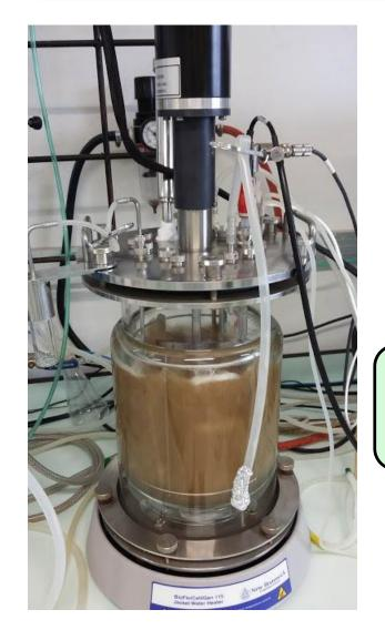
Biorreator de bancada 37°C pH 5,5 750 rpm 0,5 vvm 1 DO
