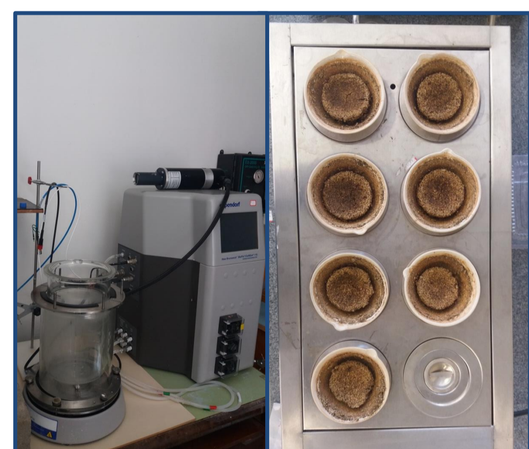
Reator New-Brunswick BioFlo / Inativação Lodo
