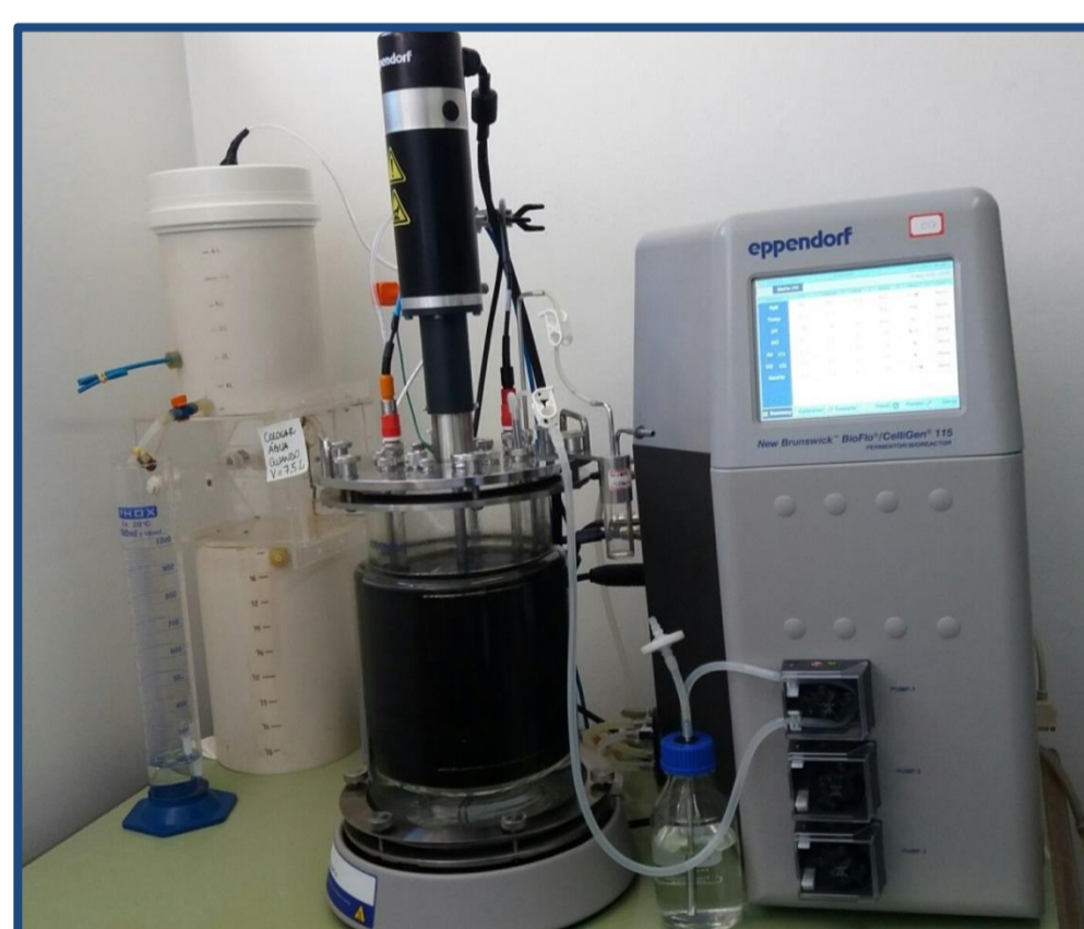
Reator New-Brunswick BioFlo em operação
